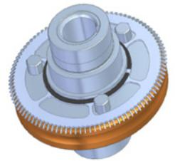
Die Fangvorrichtung tritt bei starken Verschleiß bzw. Bruch der Schneckenradzähne in Kraft. Bei Zahnbruch erfolgt zwischen Schneckenrad und Pilotrad eine Relativbewegung. Die Stege des Pilotrades geben die Raststifte frei. Durch die Druckfedern werden die Raststifte axial in die Fangtaschen vom Getriebegehäuse gedrückt. In diesem Fall ist die Getriebewelle gegen das Getriebegehäuse blockiert. Der Antrieb ist nach Auslösen der Fangvorrichtung nicht mehr verwendbar.
